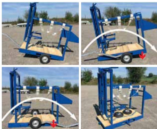
Information zur Abbildung: der Unterbau ist neu verzinkt und vorne verlängert (gleich wie bei der Version mit Gabelstapler-Aussparungen).
